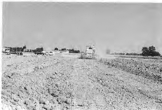
Fig.11 Senza installare un sistema automatizzato per alzare o abbassare la pala della ruspa, è possibile livellare perfettamente un terreno. In questo caso sarà il conducente che manovrerà la pala controllando il fascio luminoso proiettato sull'asta.
