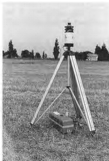
Fig.9 Ponendo il Laser e un prisma (vedi fig.7) sopra ad un cavalletto è possibile tracciare un fascio a ventaglio che, proiettato su un'asta posta sopra ad una ruspa, aiuterà il conducente a procedere secondo il livello prestabilito.
