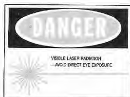
Fig.4 Per evitare che una persona incompetente possa guardare la cavità "anteriore" del tubo Laser quando questo è acceso, le Case Costruttrici consigliano di applicare una targhetta con la scritta Danger.
