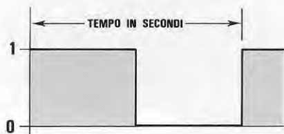
Fig.4 Sui piedini 7-5-4-6-14-13-15-1-2-3 dell'integrato CD.4060 ci ritroveremo per metà tempo, con un livello logico "1" e per l'altra metà con un livello logico "0". Nella Tabella n.2 abbiamo riportato il tempo in "secondi" in cui l'onda quadra rimane a livello logico "1".
