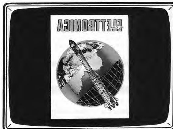
Fig.22 Il tasto M vi permetterà di rovesciare l'immagine come se fosse vista tramite uno specchio. Questa funzione vi servirà per le TELEFOTO che riceverete con scritte rovesciate.
